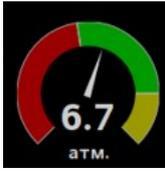
Шкала давления сжатого воздуха отображает имитацию уровня текущего давления в воздушной системе замедлителей (отображается только на пульте ДСПГ).
