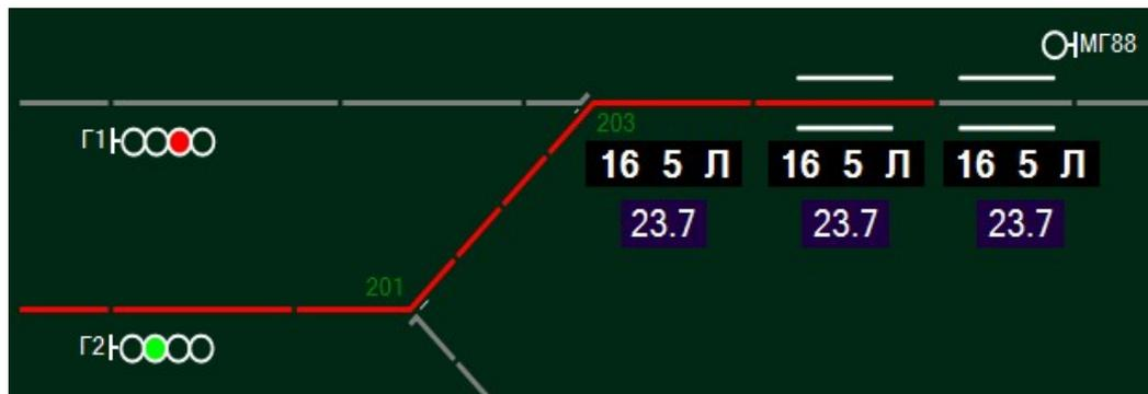
**Рисунок 102. Индикация занятого состояния рельсовых цепей и плюсового положения стрелок**
