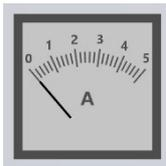
Амперметр (Рисунок 89) предназначен для отображения имитации потребления тока электроприводами стрелочных переводов (отображается только на пультах ДСПГ).
