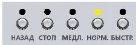
**Рисунок 6 Коммутатор скоростей ролпуска**
