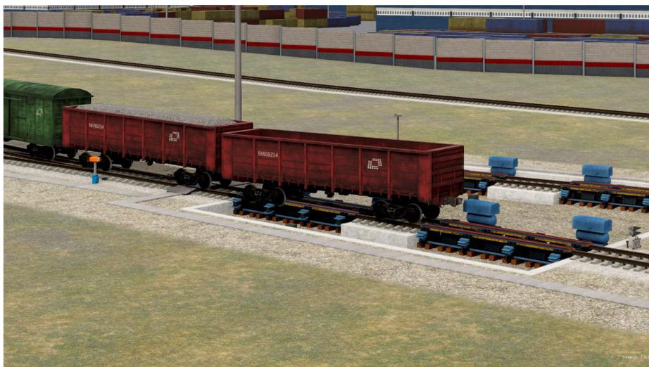
Рисунок 133. Имитация схода вагона в отцепе легкой весовой категории в результате его выдавливания на замедлителе
