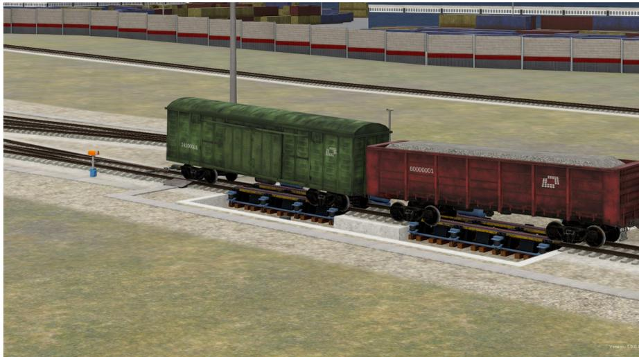
Рисунок 132. Имитация схода вагонов при нагоне на горке
