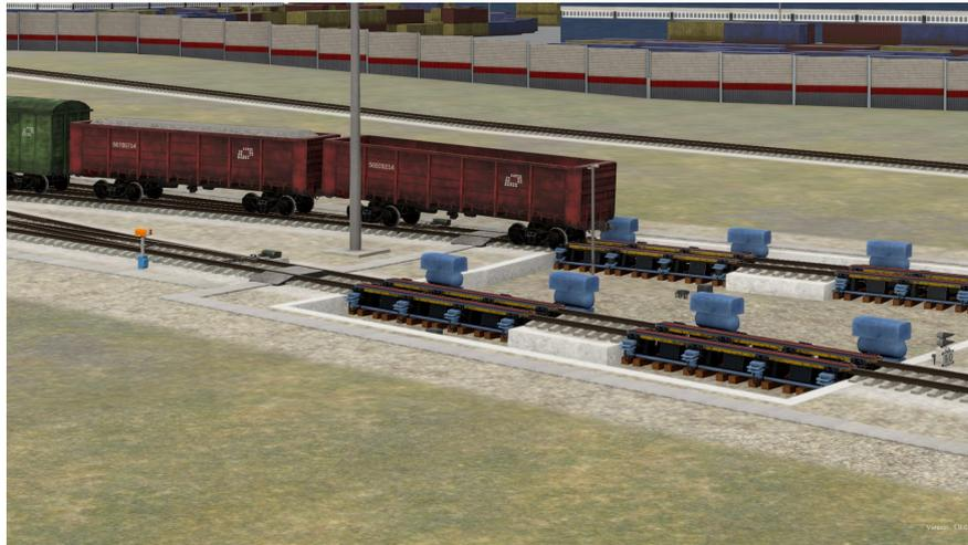
**Рисунок 134. Имитация схода вагона в результате его входа на включенный замедлитель**
