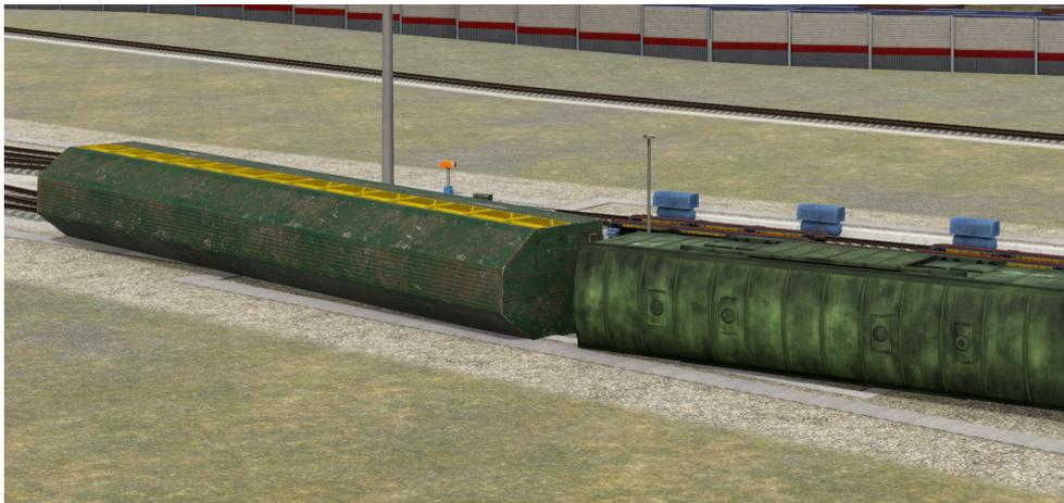
**Рисунок 139. Имитация схода вагонов с опрокидыванием в результате столкновения отцепов на относительной скорости более 25 км/ч при необеспечении габаритности стрелочного участка**
