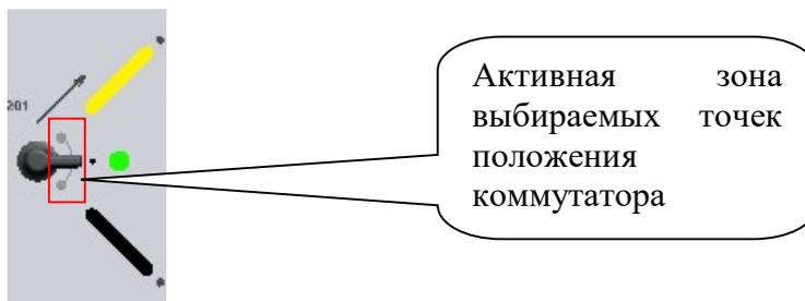
Рисунок 68. Активная зона выбираемых точек положения коммутатора
